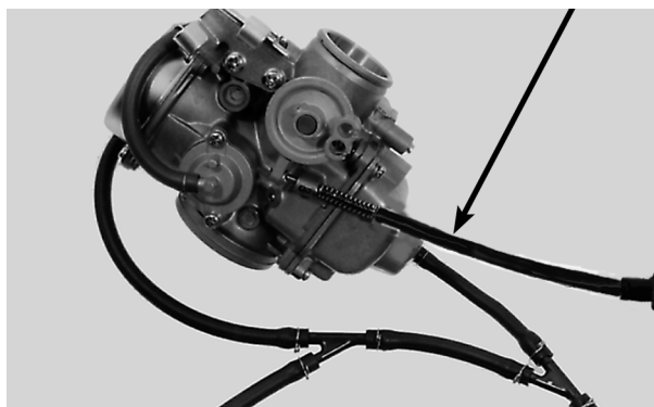
PARAFUSO DE CONTROLE DE ACELERAÇÃO
