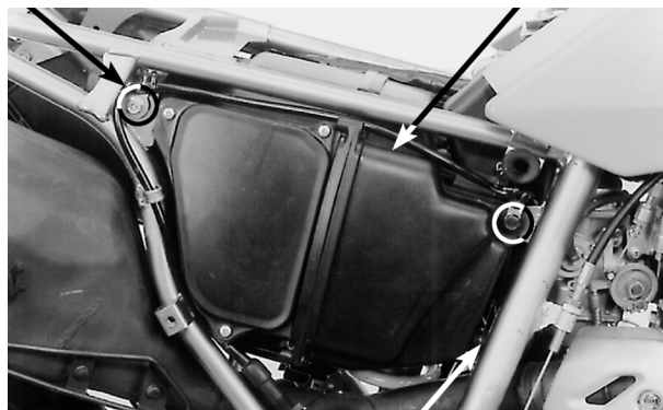
TUBO DE RESPIRO DA CARÇA DO MOTOR
